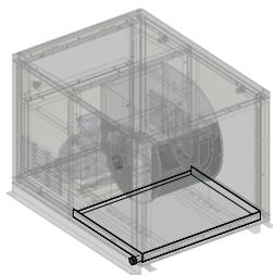
Panneau bac étanche en acier galvanisé, intérieur au caisson, avec purge bouchonnée  $\varnothing 3/4$ . Trou de purge de volute monté sur le ventilateur.
