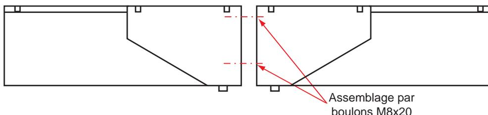
**ASSEMBLAGE DE MODULES MONOBLOCS :** Oter la barre de maintien pour transport. Faire un joint silicone sur la périphérie (nous recommandons SILICOMETRE 700°). Avec la visserie M6 fournie, assembler les modules. Vérifier le niveau de chaque module.
