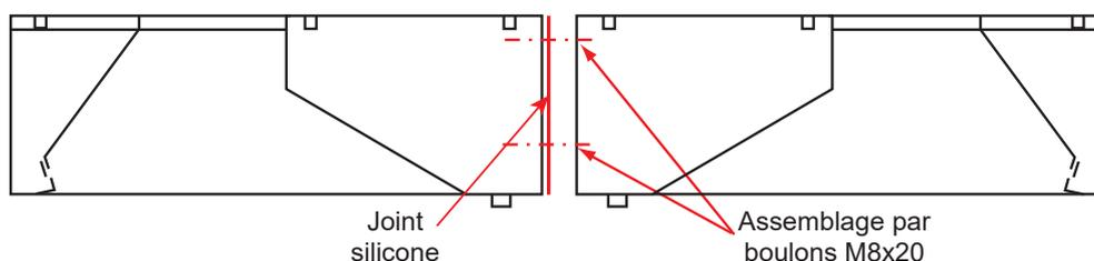
**ASSEMBLAGE DE MODULES MONOBLOCS :** Oter la barre de maintien pour transport.
