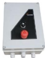
Boîtier de commande 2 vitesses, triphasé 400V pour moteur type Dalhander (rapport 1/2) ou bobinages séparés (rapport 2/3 – 1/3). Existe avec coup de poing en façade ou déporté.
