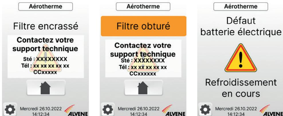
L'encrassement du filtre est détecté par le système. Un message d'erreur apparait quand le filtre est encrassé ou obturé. Dans tous les cas le système peut redémarrer mais un indicateur de rappel clignote sur l'écran principal.
