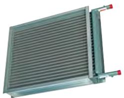
Batterie à eau 2 rangs tube cuivre, ailettes aluminium, collecteurs en acier à embout fileté (filetage gaz).
